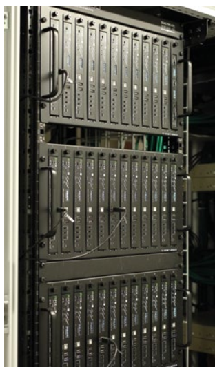
19-Zoll-Rack mit 36 Transceiver-Units für die große Bühne.
