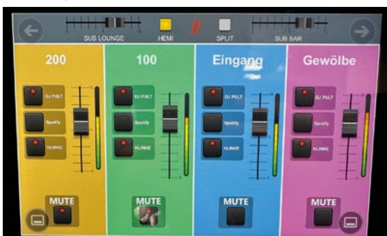
Ein Touchpanel erleichtert dem Personal die Bedienung der Soundanlage und die Steuerung des Systems.
