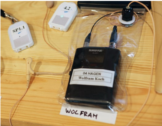
Wasserfest in eine Handyhülle eingepacktes Bodypack samt passender Verschraubung für die Leitungsführung
