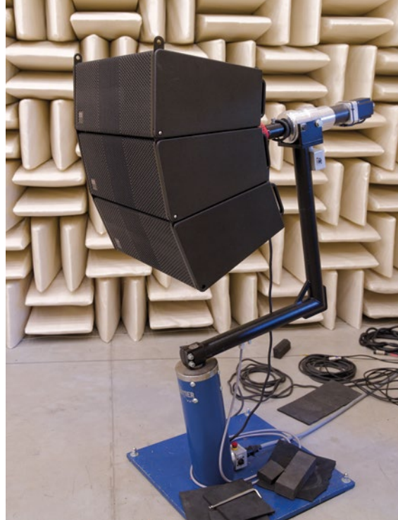
3er-Array an der ELF-Maschine zur Messung des Abstrahlverhaltens in Abhängigkeit vom Winkel der Boxen zueinander. Es wurde mit Box-to-Box-Winkeln von 0°, 6° und 12° gemessen
