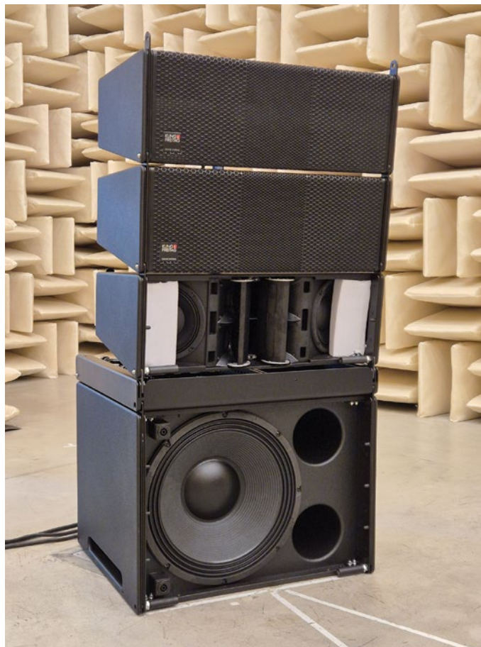
Ein kleines Set bestehend aus drei Sequenza-Topteilen S8N und einem Subwoofer S8B im reflexionsarmen Raum für die Maximalpegelmessung
