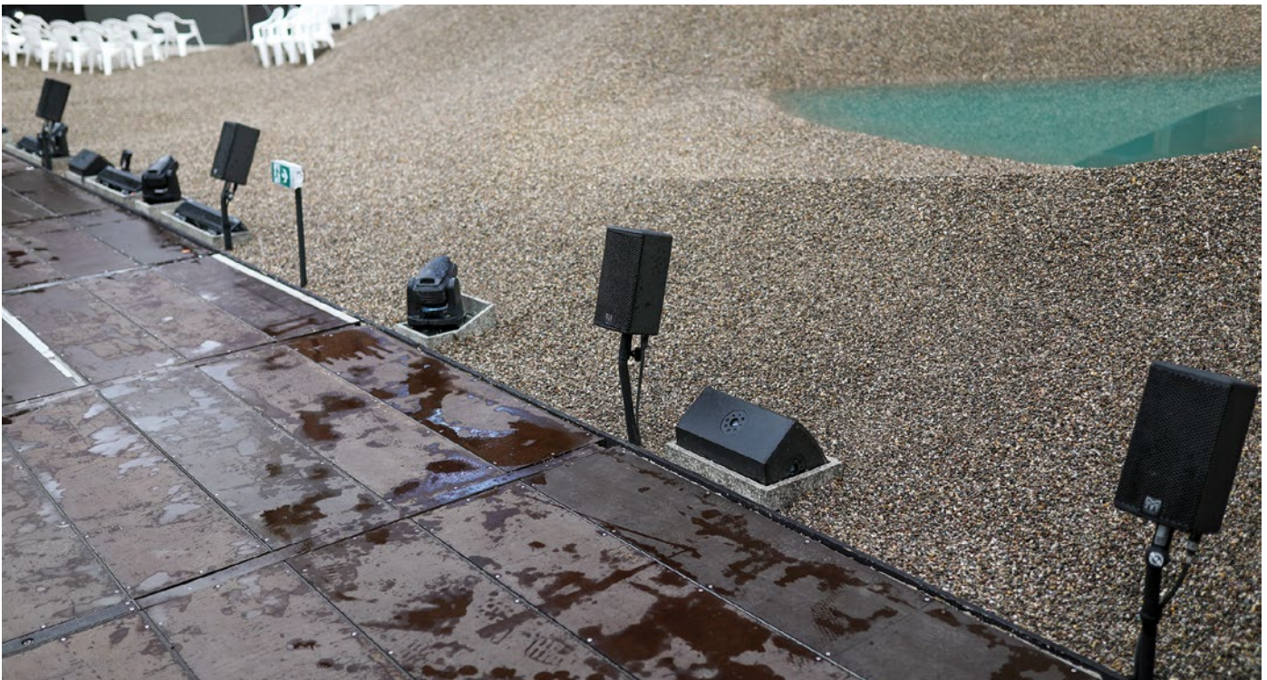
Nahfeldlautsprecher Martin DD6 am vorderen Bühnenbereich sowie Bühnenmonitore Adamson Point8
