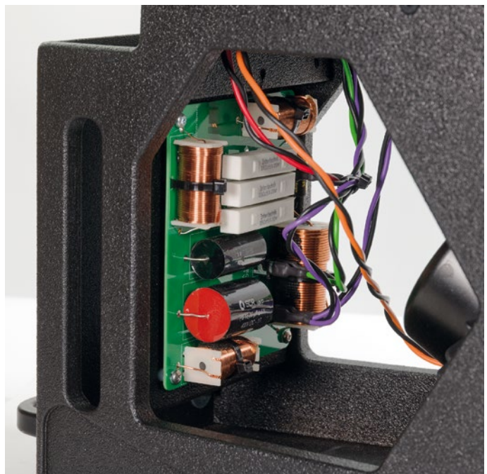
Eine der zwei Platinen mit passiven Filtern
