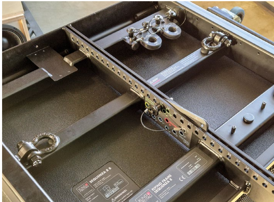
Flugrahmen zum Sequenza 8 der sowohl für die Subwoofer mit Vierpunkt-Mechanik wie auch für die Tops mit einer Dreipunkt-Flugmechanik sowie als Zwischenrahmen genutzt werden kann
