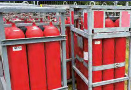
12er-Bündel mit 300 bar Wasserstoff in 50-L-Flaschen
