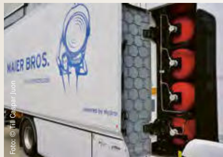
Der Wasserstoff wird in sieben Behältern gespeichert
