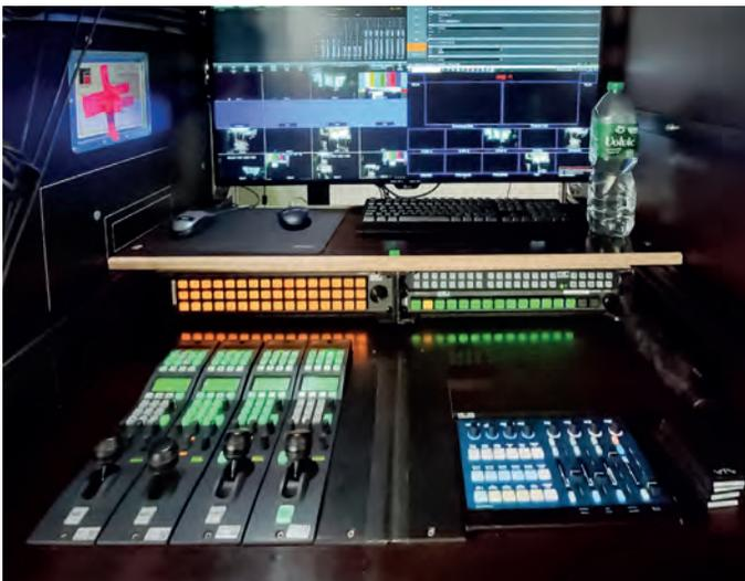
**Camera Control Unit** für die Broadcast Kameras am FoH, rechts daneben die Skaarhoj Color Fly Unit für die übrigen Kameras
