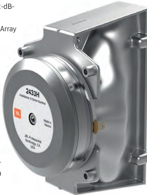
**Hochtöner JBL 2433H** mit Neodym-Antrieb und 3“-Schwingspule, das Waveguide für die ebene Wellenfront ist bereits im Hochtoner integriert.
