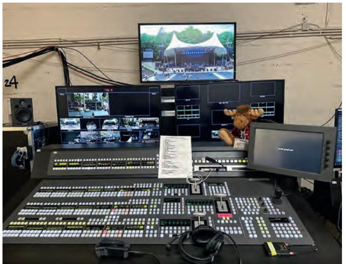
**Grass Valley Karrera 3 M/E Pult** (mit einem Aux Panel) an Penta 42"-HD2line-Broadcast-Monitoren kontrolliert; die Regie ist manchmal unkonventionell positioniert
