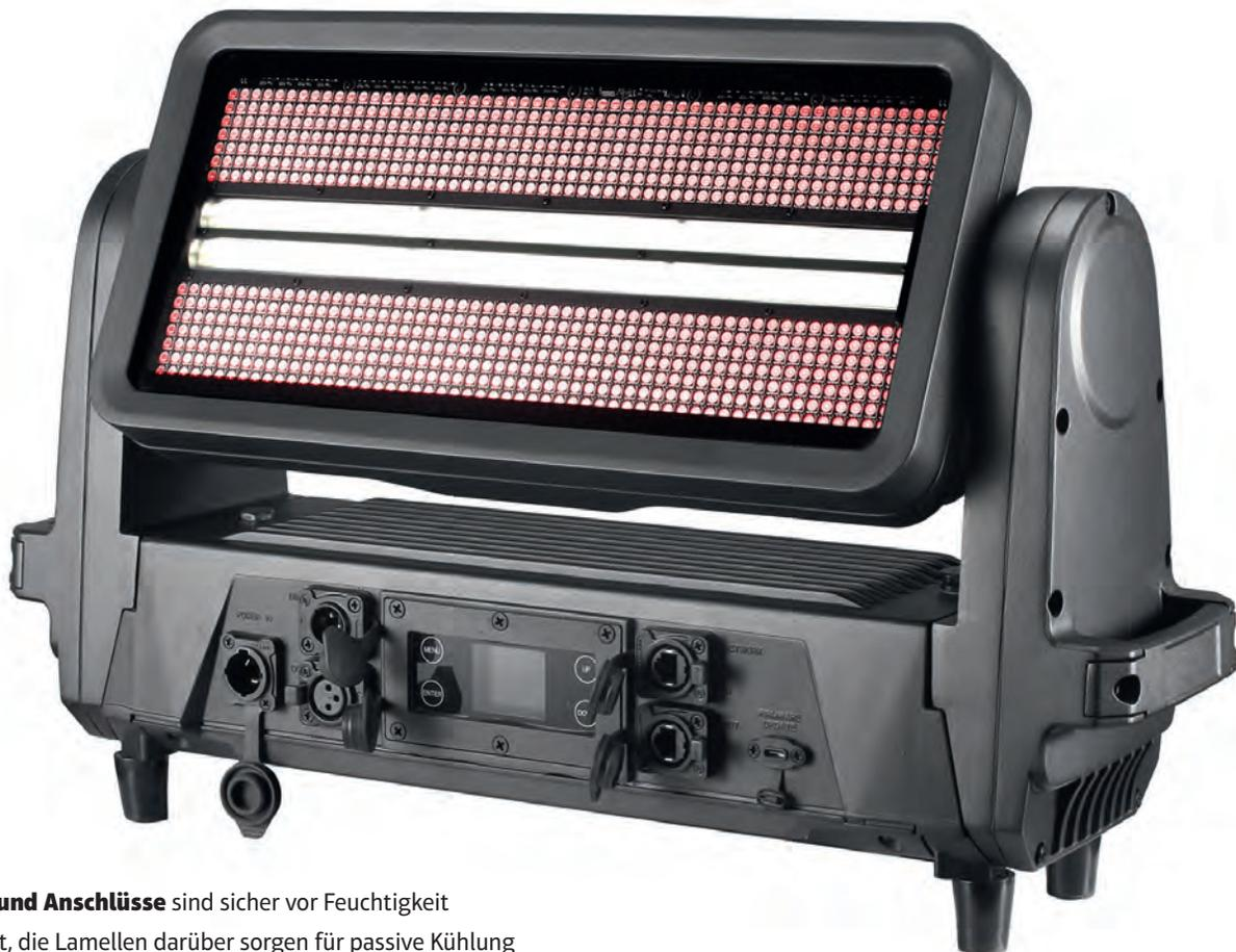
**Display und Anschlüsse** sind sicher vor Feuchtigkeit geschützt, die Lamellen darüber sorgen für passive Kühlung und leiten Regenwasser von den Anschlüssen weg
