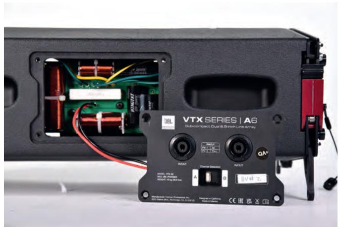
**Passive Weiche der A6** hinter der Anschlussplatte
